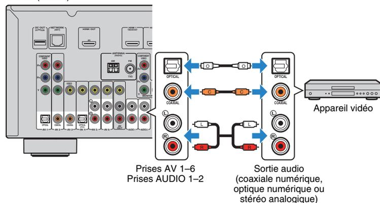
Si vous appuyez sur AV 1-6 ou AUDIO 1-2 pour sélectionner la source d'entrée, les signaux audio lus par l'appareil audio seront restitués sur l'unité.
