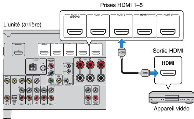
Si vous appuyez sur HDMI 1-5 pour sélectionner la source d'entrée, les signaux vidéo/audio lus par l'appareil vidéo seront restitués sur l'unité.
