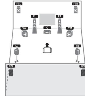
Parfaitement adapté pour des contenus 5.1-voies, ce système d'enceintes utilise les enceintes de présence avant et arrière afin de produire un champ sonore stéréoscopique particulièrement naturel.
