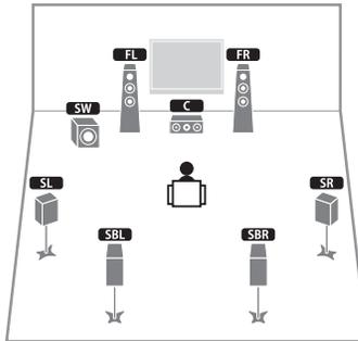
Ce système d'enceintes crée une enceinte de présence virtuelle en utilisant les enceintes avant, centrale et d'ambiance afin de produire un champ sonore stéréoscopique. Il vous permet également de bénéficier d'un son surround étendu grâce aux enceintes d'ambiance arrière.
