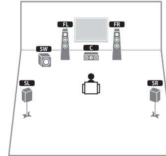
Parfaitement adapté aux contenus 5.1-voies, ce système d'enceintes crée une enceinte de présence virtuelle en utilisant les enceintes avant, centrale et d'ambiance afin de produire un champ sonore stéréoscopique.
