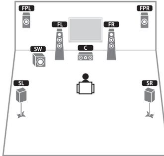
Parfaitement adapté pour des contenus 5.1 voies, ce système d'enceintes utilise les enceintes de présence avant afin de produire un champ sonore stéréoscopique naturel.
