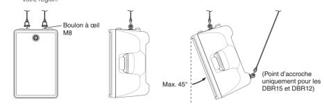
Fixez les boulons à œil en vente dans le commerce (M8 x 15 mm) sur les trous de vis situés sur la partie
