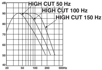
Les graphiques ci-dessous illustrent le réglage optimal de chaque commande et les caractéristiques de fréquence lorsque ce caisson de graves est associé à des enceintes avant classiques.
