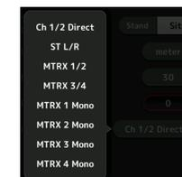
Ch 1/2 Direct correspond à la sortie avant le fader, et ST L/R, AUX et MTRX correspondent aux sorties après le fader.
