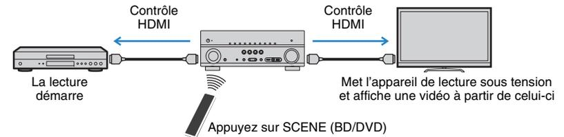
Pour utiliser le contrôle HDMI, vous devez procéder au réglage de la liaison du contrôle HDMI suivant après avoir raccordé le téléviseur et les appareils de lecture.
