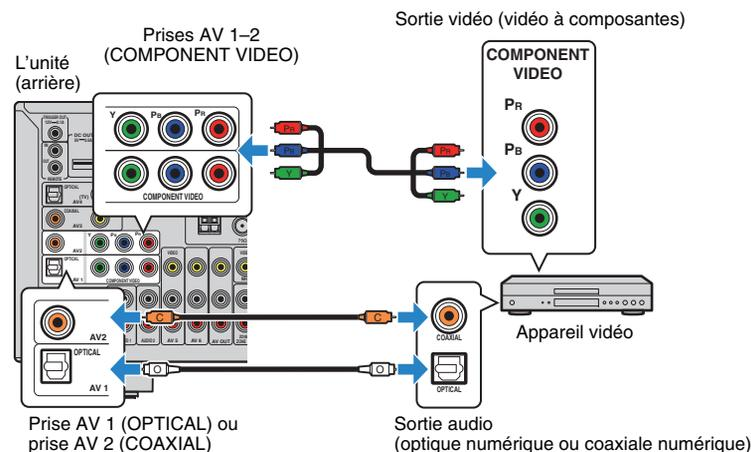
Si vous appuyez sur AV 1-2 pour sélectionner la source d'entrée, les signaux vidéo/audio lus par l'appareil vidéo seront restitués sur l'unité.
