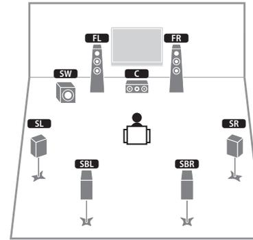
Ce système d'enceinte forme une Virtual Presence Speaker (VPS) en utilisant les enceintes avant, centrales et d'ambiance afin de produire un champ sonore 3D. Il vous permet également de bénéficier d'un son surround étendu grâce aux enceintes d'ambiance arrière.
