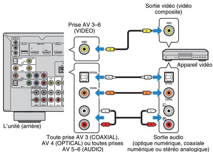
Si vous appuyez sur AV 3-6 pour sélectionner la source d'entrée, les signaux vidéo/audio lus par l'appareil vidéo seront restitués sur l'unité.
