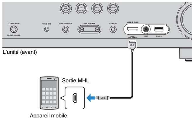
Si vous appuyez sur V-AUX pour sélectionner la source d'entrée « V-AUX », les signaux vidéo/audio lus par l'appareil mobile seront restitués sur l'unité.
