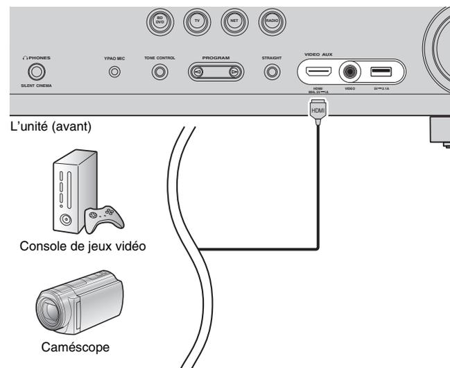
Si vous appuyez sur V-AUX pour sélectionner la source d'entrée « V-AUX », les signaux vidéo/audio lus par l'appareil vidéo seront restitués sur l'unité.
