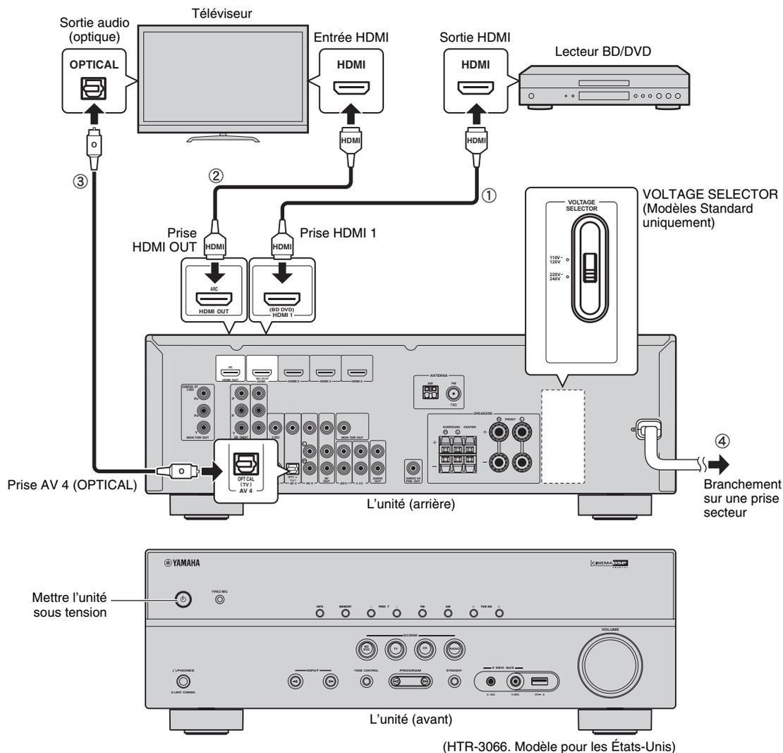
Avant de raccorder le câble d'alimentation (modèle standard uniquement)
