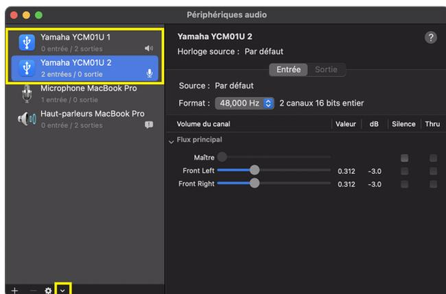
**3 Quand « Yamaha YCM01U 1 » (sortie) est sélectionné, cliquez sur  dans le coin inférieur gauche de la fenêtre, puis cliquez sur « Utiliser ce périphérique pour la sortie audio ».**
