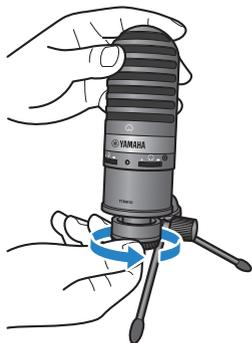
**3 Si nécessaire, ajustez l'angle du microphone en desserrant la molette de serrage tout en maintenant le microphone, puis resserrez la molette.**
