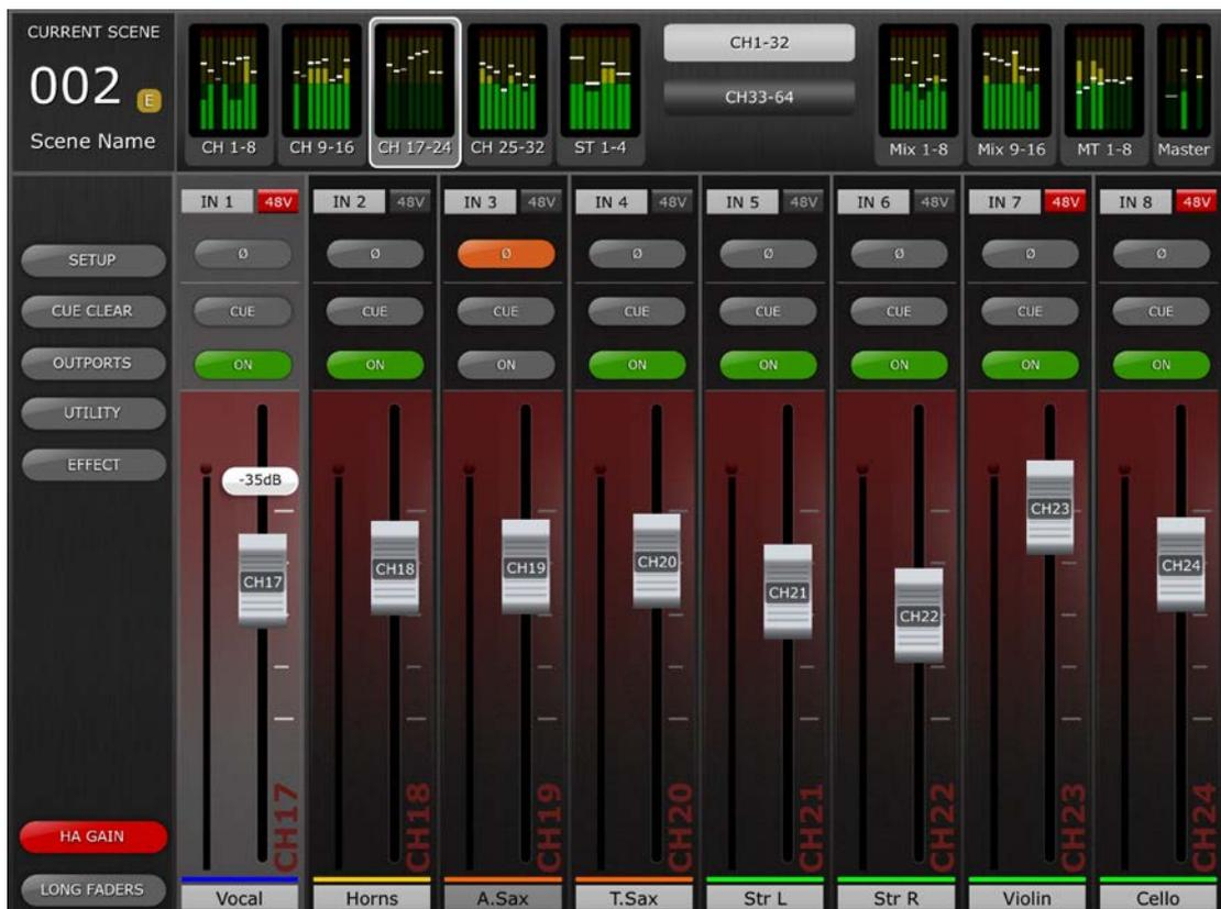
Vous pouvez déplacer les faders pour modifier le gain de préampli micro sur les canaux correspondants. La valeur de gain de chaque préampli micro s'affiche au dessus du fader concerné dès que vous en touchez le capuchon. Il est possible de régler un maximum de 8 faders en simultanément.
