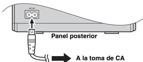
Una vez finalizadas todas las conexiones, conecte el cable de alimentación suministrado a la toma AC IN y conecte el conector del cable a una toma de CA.
