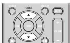
Durante la reproducción de un CD de datos, puede utilizar los botones **FOLDER ▲/▼** del mando a distancia para seleccionar la carpeta.
