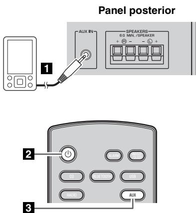
**1** Con un cable con miniconector estéreo de 3,5 mm de venta en tiendas, conecte el dispositivo externo al conector **AUX** en la parte posterior de esta unidad.
