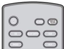
Appuyez plusieurs fois de suite sur **SNOOZE/SLEEP** pour régler le délai avant la mise hors tension de l'appareil.
