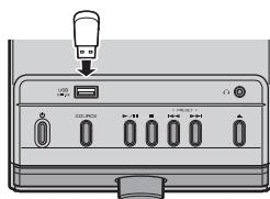
Conecte el dispositivo USB al puerto USB en el panel superior. Para obtener información sobre los archivos reproducibles, consulte “NOTAS SOBRE LOS DISCOS Y LOS DISPOSITIVOS USB” (☞ P.21).
