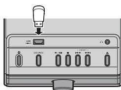
Branchez votre dispositif USB au port USB du panneau supérieur. Pour plus de détails sur les types de fichiers compatibles, lisez « REMARQUES SUR LES DISQUES ET DISPOSITIFS USB » (☞ P.21).
