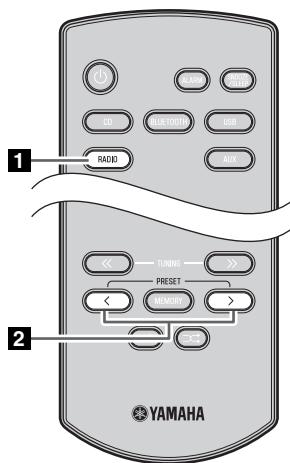
**1** Pulse el botón de fuente **RADIO** para cambiar la fuente de audio a FM o AM.
