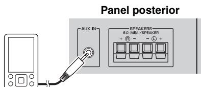
Con un cable con miniconector estéreo de 3,5 mm de venta en tiendas, conecte el dispositivo externo al conector AUX en la parte posterior de esta unidad.
