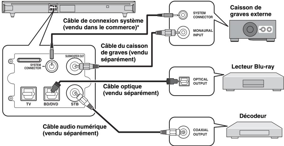
\* Si vous raccordez un caisson de graves externe de marque Yamaha, utilisez le câble fourni avec le caisson de graves pour l'activation/la désactivation synchrone de l'appareil et du caisson.
