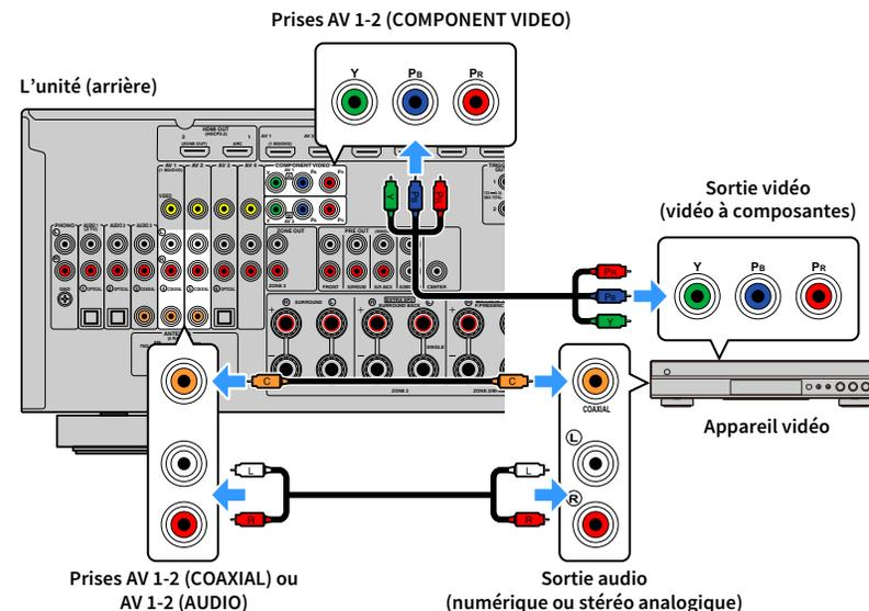
Si vous appuyez sur AV 1-2 sur la télécommande pour sélectionner la source d'entrée, les signaux vidéo/audio lus par l'appareil vidéo seront restitués sur l'unité.
