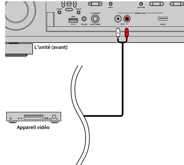
Si vous appuyez sur V-AUX pour sélectionner la source d'entrée « VIDEO AUX », le signal audio lu par l'appareil vidéo est restitué sur l'unité.
