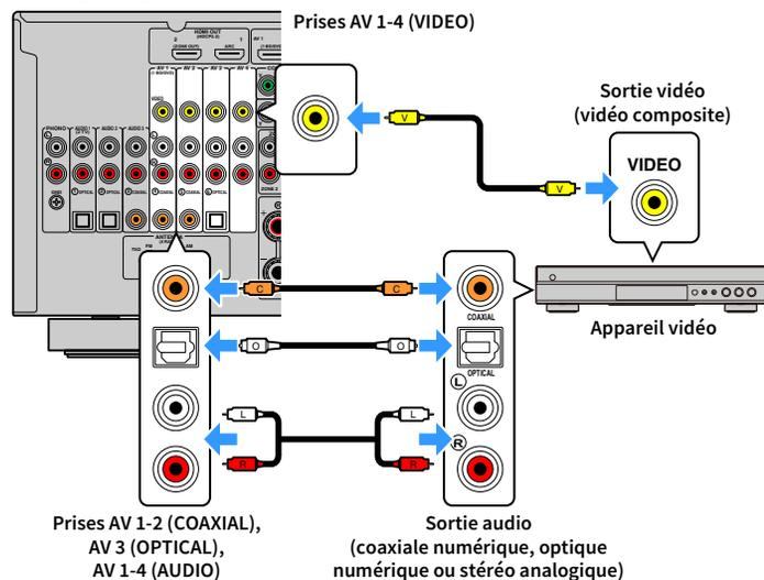
Si vous appuyez sur AV 1-4 sur la télécommande pour sélectionner la source d'entrée, les signaux vidéo/audio lus par l'appareil vidéo seront restitués sur l'unité.
