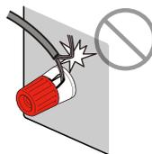
Si « Vérifier câbles HP » apparaît sur l'afficheur de la face avant à la mise sous tension de l'unité, mettez-la hors tension et vérifiez ensuite s'il n'y a pas un court-circuit au niveau des connexions de câbles d'enceintes.
