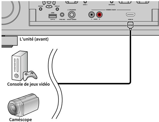
Si vous appuyez sur V-AUX pour sélectionner la source d'entrée « VIDEO AUX » sur la télécommande, les signaux vidéo/audio lus par l'appareil seront restitués sur l'unité.
