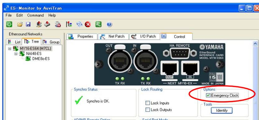
Dans le cas d'une défaillance du câble, cette horloge sera utilisée dans l'intervalle, jusqu'à établissement d'un nouveau master de wordclock.
