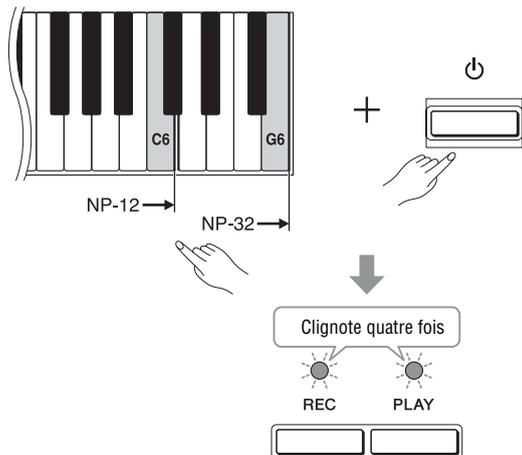
Tout en maintenant la touche la plus à droite enfoncée, mettez l'instrument sous tension pour initialiser les données sauvegardées sur les réglages définis en usine.
