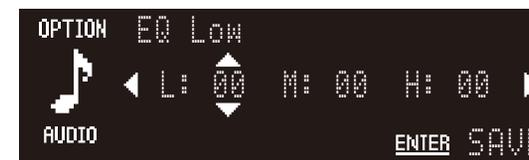
Appuyez sur ▲/▼ pour changer de niveau. Appuyez sur ◀/▶ pour sélectionner une tonalité. Appuyez sur **ENTER** pour terminer la configuration.
