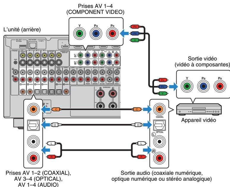
Si vous appuyez sur AV 1-4 sur la télécommande pour sélectionner la source d'entrée, les signaux vidéo/audio lus par l'appareil vidéo seront restitués sur l'unité.
