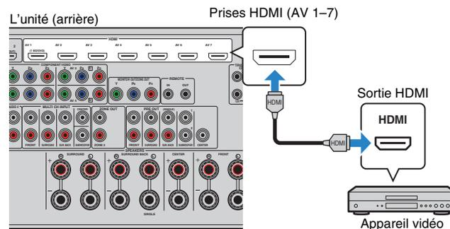
Si vous appuyez sur AV 1-7 sur la télécommande pour sélectionner la source d'entrée, les signaux vidéo/audio lus par l'appareil vidéo seront restitués sur l'unité.
