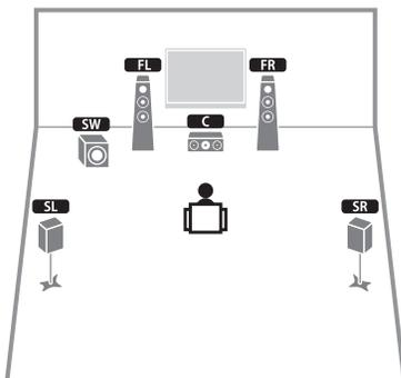
Parfaitement adapté pour des contenus 5.1 voies, ce système d'enceintes crée une Virtual Presence Speaker (VPS) en utilisant les enceintes avant, centrales et d'ambiance afin de produire des champs sonores 3D.
