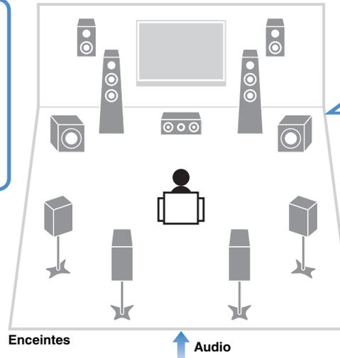
Prise en charge d'enceintes en configuration 2 à 7 voies (et des enceintes de présence avant) ainsi que du raccordement de 2 caissons de graves. Permet de profiter d'espaces acoustiques avec des styles de musique variés.
