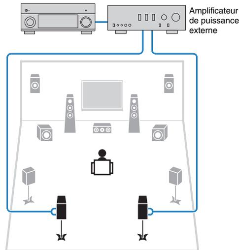
**Utilisation des amplificateurs intégrés supplémentaires pour les enceintes stéréo dans une autre pièce**
