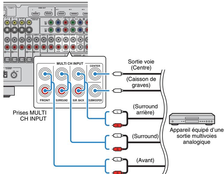
Si vous appuyez sur MULTI pour sélectionner la source d'entrée « MULTI CH » sur la télécommande, les signaux audio lus par l'appareil seront restitués sur l'unité.
