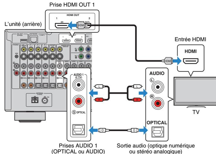
Si vous appuyez sur AUDIO 1 ou sur SCENE(TV) sur la télécommande pour sélectionner la source d'entrée « AUDIO 1 », les signaux audio du téléviseur sont restitués sur l'unité.
