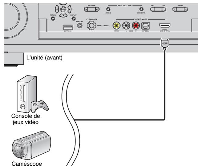
Si vous appuyez sur V-AUX pour sélectionner la source d'entrée « V-AUX » sur la télécommande, les signaux vidéo/audio lus par l'appareil seront restitués sur l'unité.
