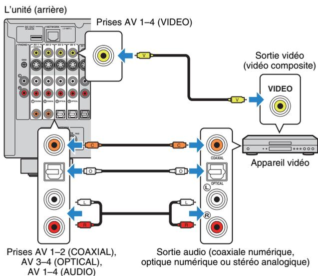
Si vous appuyez sur AV 1-4 sur la télécommande pour sélectionner la source d'entrée, les signaux vidéo/audio lus par l'appareil vidéo seront restitués sur l'unité.
