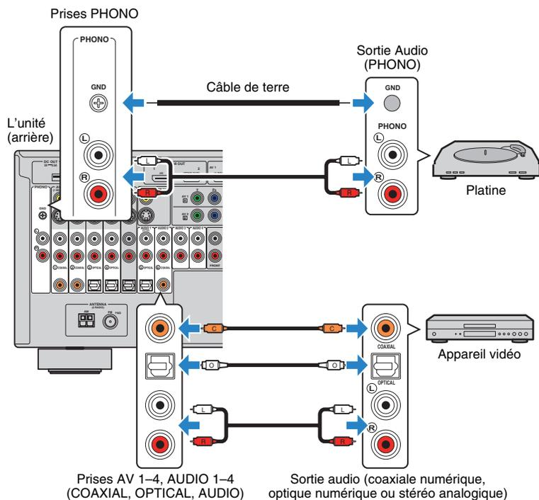
Si vous appuyez sur AV 1-4, AUDIO 1-4 ou sur PHONO sur la télécommande pour sélectionner la source d'entrée, les signaux audio lus par l'appareil audio seront restitués sur l'unité.
