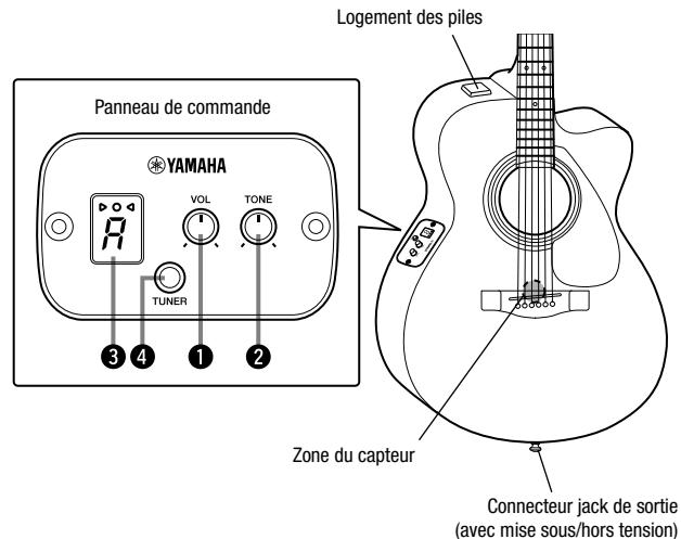
**Le préamplificateur intégré est automatiquement mis sous tension lorsqu'un câble est branché dans la prise jack de sortie de la guitare.**
