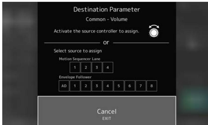
Déplacez le contrôleur que vous souhaitez utiliser pour modifier le paramètre, ou sélectionnez-en un dans le *Motion Sequencer Lane* (Voie du séquenceur de mouvement) ou l'*Envelope Follower* (Suiveur d'enveloppe).
