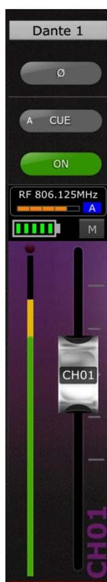
Au-dessus du témoin de charge et du voyant d'assourdissement se trouve l'indicateur de mesure d'intensité des radiofréquences et l'indication A/B de la diversité.
