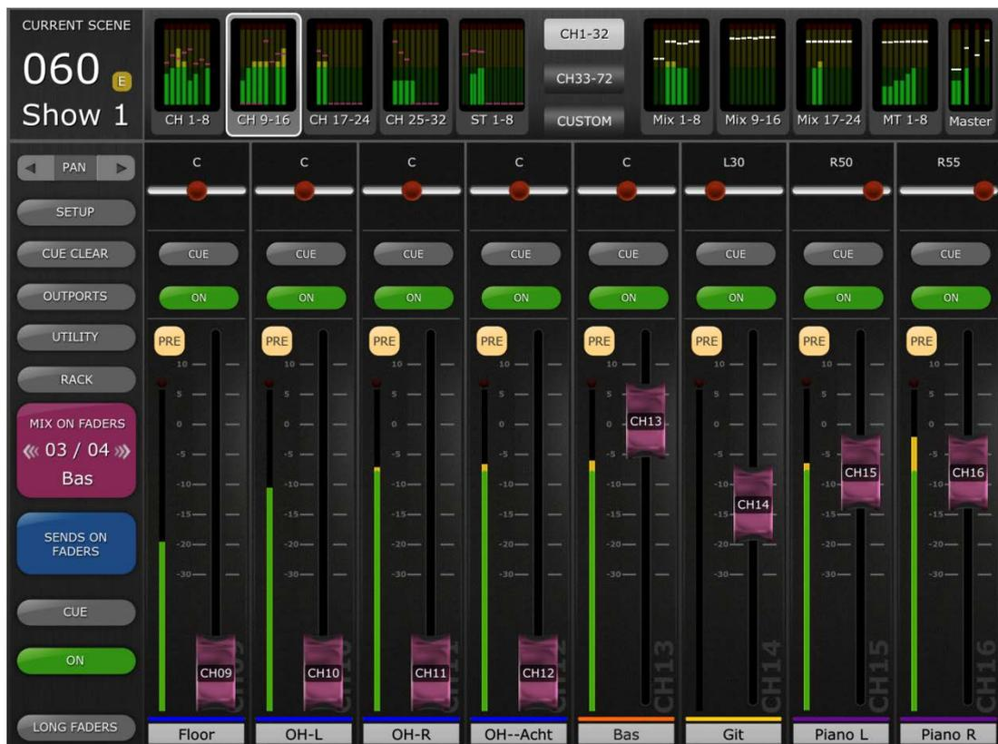
Une large touche [MIX ON FADERS] (Mixage de faders activé) affiche le numéro et le nom du bus Mix ou Matrix actuellement sélectionné. La couleur de cette touche correspond à celle des touches utilisées sur la console de série CL.
