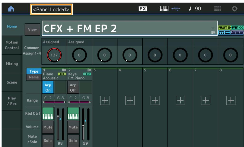
Pour déverrouiller le panneau, appuyez à nouveau sur [SHIFT] + [AUDITION]. Lorsque la fonction Panel Lock est activée, la plupart des opérations sont indisponibles, à l'exception des opérations liées au clavier, aux pédales, au volume principal, à Super Knob, à la molette de variation de ton, à la molette de modulation et à l'opération de déverrouillage. Le verrouillage s'applique également aux opérations liées à l'écran tactile.
